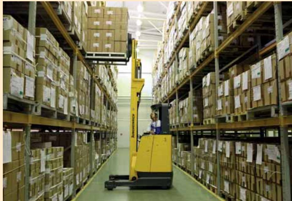
учитывает все требования GMP, отвечает современным логистическим стандартам и технологиям: высокостеллажность, узкопроходная технология, специальная техника - узкопроходные высотные штабелеры, обеспечивающие эффективное выполнение операций при безопасности перемещений, лин-лифт, а также резервная система энергообеспечения.
