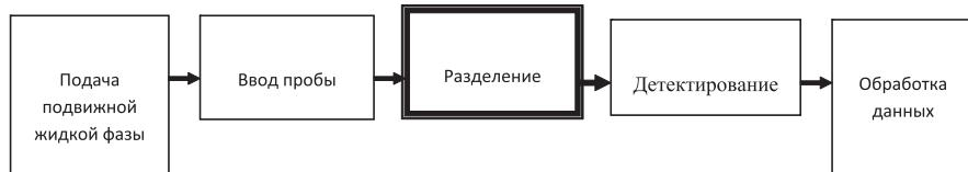
Блок-схема жидкостного хроматографа
